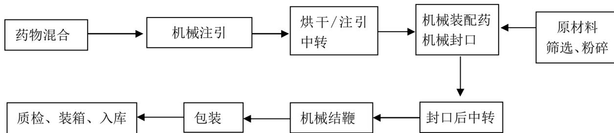
图 2-1：爆竹生产（注引）工艺流程图
