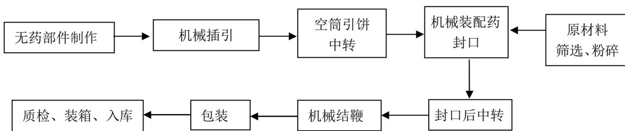
图 2-2：爆竹生产（插引）工艺流程
