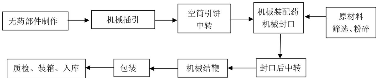
图 2-4：爆竹生产（插引）生产工艺流程图
