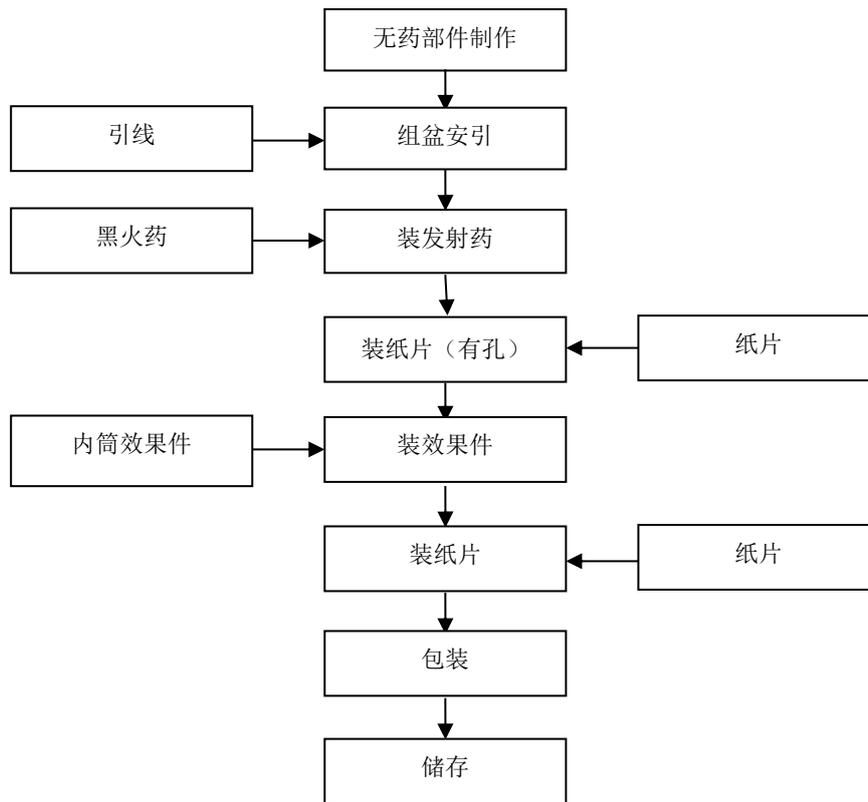
图 2-1：组合烟花生产工艺流程图
