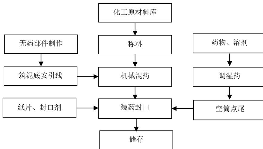
图 2-2：效果内筒生产工艺流程图
