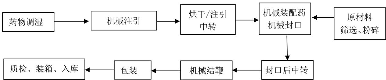
图 2-3：爆竹生产（注引）生产工艺流程图
