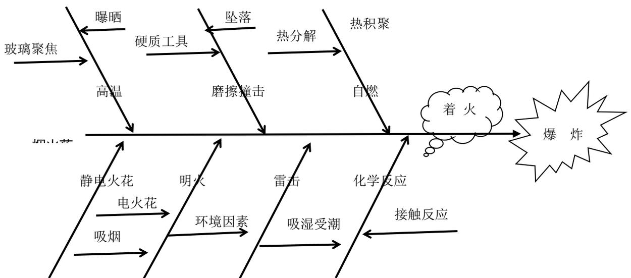
图 3-11 烟火药燃烧、爆炸触发条件分析图
