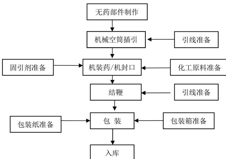
图 2-4 爆竹类产品生产工艺流程图
