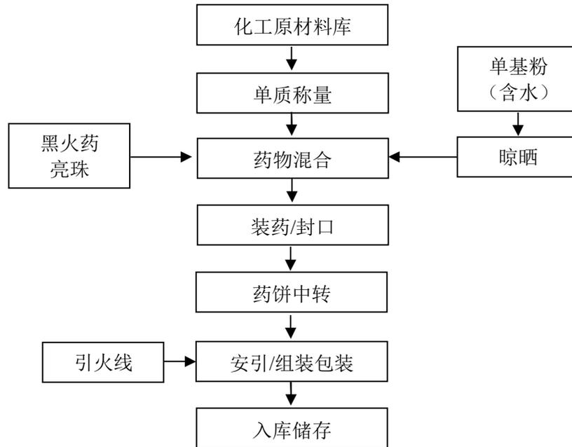
图 2.3-1：喷花类产品生产工艺流程图
