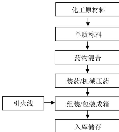
图 2.3-6：升空类（旋转升空烟花）产品生产工艺流程图
