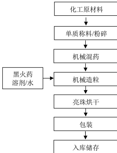
图 2.3-7：烟火药（亮珠）生产工艺流程图
