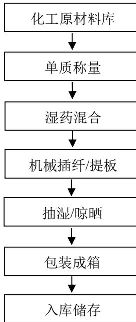
图 2.3-5：玩具类（线香型-电光花）生产工艺流程图
