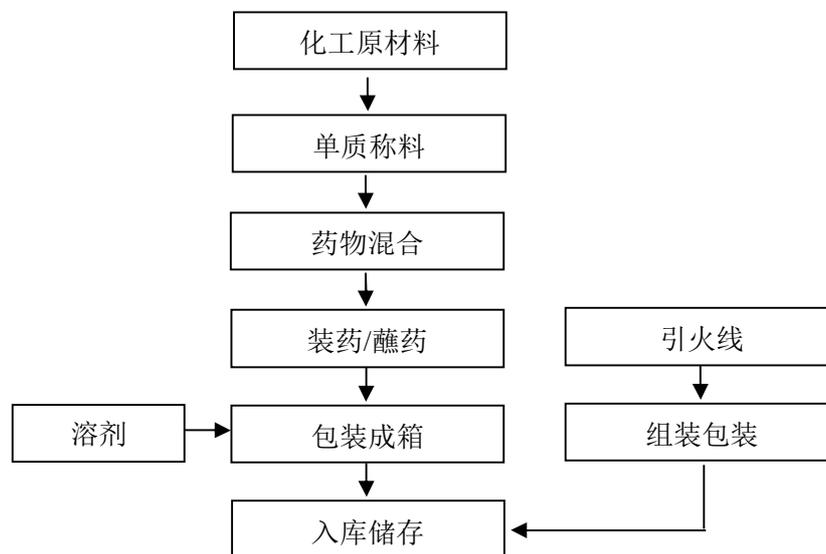
图 2.3-4：玩具类（线香型-晨光花）产品生产工艺流程图
