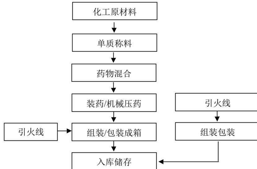
图 2.3-2：旋转类产品生产工艺流程图
