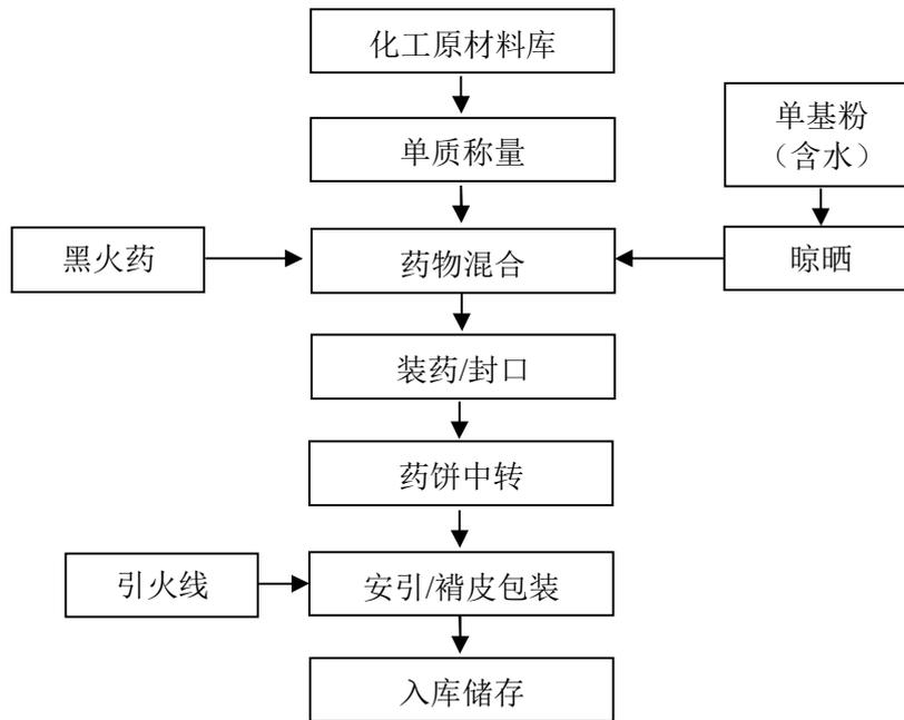
图 2.3-3：玩具类（玩具造型）生产工艺流程图
