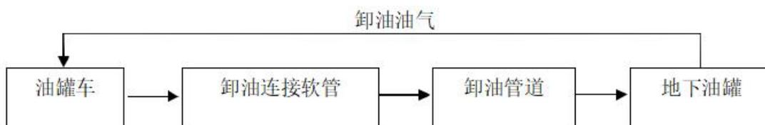
图 2.2-2 接卸柴油油工艺流程图
