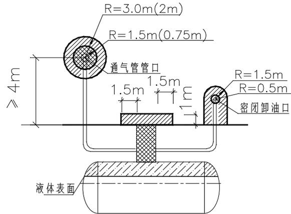
图3.10-1 埋地卧式汽油储罐爆炸危险区域划
