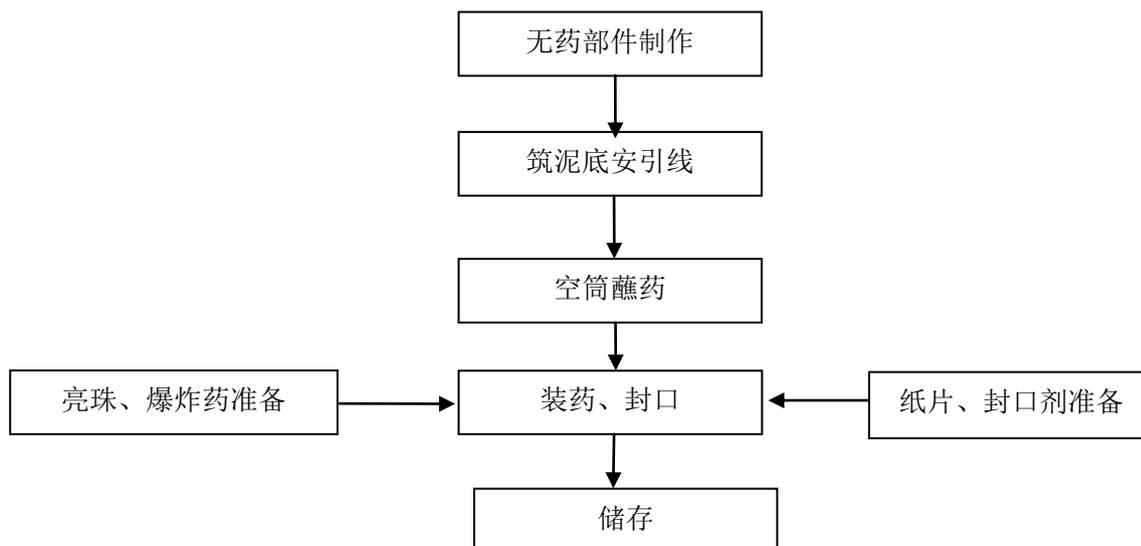
图 2.4-2 效果内筒生产工艺流程图
