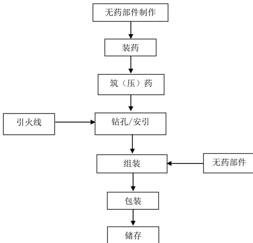
图 2.4-6 升空类（旋转升空）生产工艺流程图
