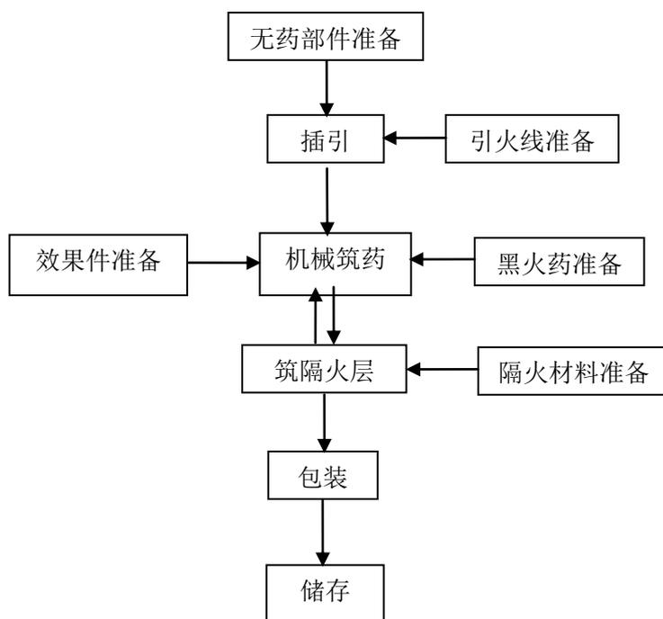
图 2.4-5 吐珠类产品生产工艺流程图
