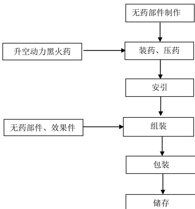
图 2.4-7 升空类（火箭）产品生产工艺流程图
