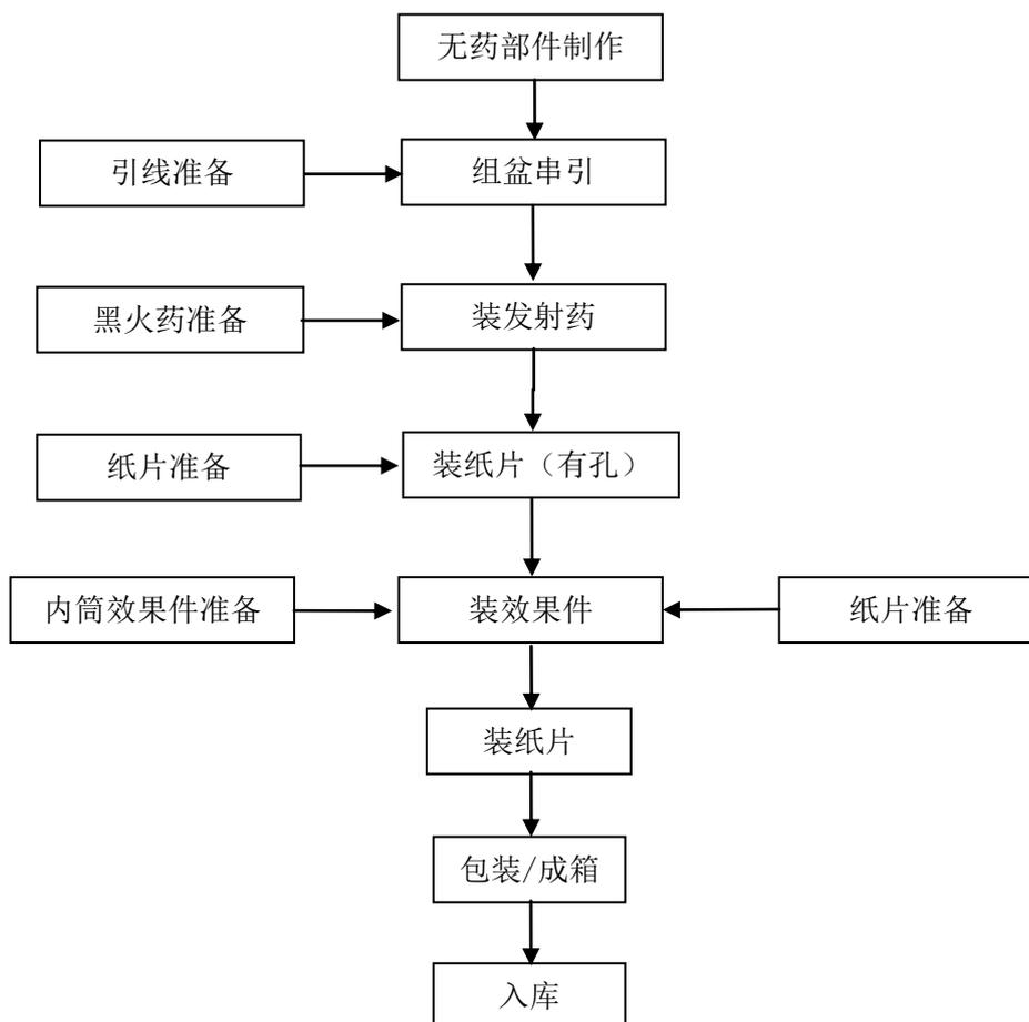
图 2.4-3 组合烟花类产品生产工艺流程图
