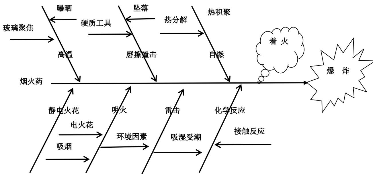
图 3.11-3 烟火药燃烧、爆炸触发条件分析图
